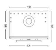
vent outlet: 4,72 Ø firebreak: 5,90 Ø
