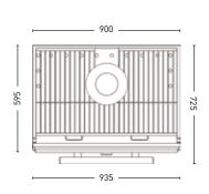
vent outlet: 4,72 Ø firebreak: 5,90 Ø
